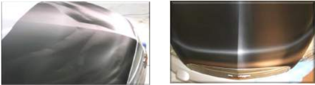
Figura 2. Film danneggiato vs. Film non danneggiato post-installazione
